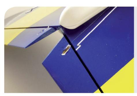
Nachdem das V-Leitwerk hinten auf den Leitwerksträger aufgeschraubt ist, können Sie die Positionen der Ruderhörner ermitteln und an den Ruder flächen anzeichnen.
