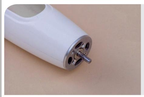
Je nach gewählter Ausführung des Spirit ist der Motor bereits montiert, bzw. muss noch in die Rumpfnase an den Motor Spant geschraubt werden. Anschließend kann die Luftschraube mit dem Spinner montiert werden.
