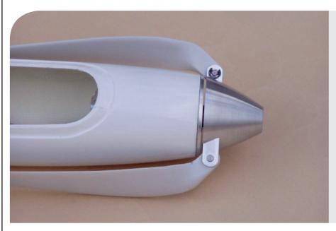
Die Befestigung der Kabinenhaube erfolgt durch den eingeklebten Stahldraht. Neben dem Akku findet der Regler gerade noch Platz. Durch Verschieben des Flugakkus kann der Schwerpunkt ohne Zugabe von Blei eingestellt werden.
