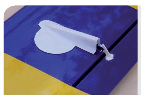
Nachdem alle Ruder angelenkt sind, werden die Abdeckungen für die Servos auf der Tragfläche montiert. Schneiden Sie die beiliegenden Servoabdeckungen aus. Schieben Sie die Abdeckung über die Anlenkung und kleben Sie diese mit Tesafilm auf der Folie fest.
