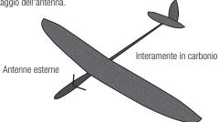
Inserire nel foro l'antenna con il suo cavetto finché la punta non esce completamente dalla fusoliera per 31mm più almeno 2mm di cavetto. Usare una goccia di colla CA per fissare l'antenna.
